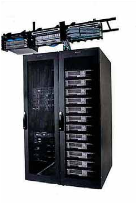
Рисунок 4. Шкаф InstaPATCH ZERO, совместная разработка Commscope и Rittal, ускоряет подключение серверов благодаря наличию претерминированной кабельной системы.
