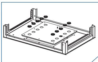
В стандартную комплектацию шкафа входят: корпус, дверь, ограничитель двери, задняя стенка и оцинкованная монтажная панель. Дополнительно шкафы могут комплектоваться боковыми стенками и цоколем различной высоты.
