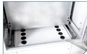
Основа конструкции шкафа – сварной корпус, выполненный из стали 2 мм. Имеет перфорацию для удобного крепления аксессуаров. В верхней и нижней частях расположены кабельные вводы 360x360 мм, закрытые металлическими заглушками. Заглушка нижнего кабельного ввода имеет десять отверстий диаметром 34 мм с резиновыми уплотнителями. В верхней части рамы установлены четыре транспортировочных рым-болта.
