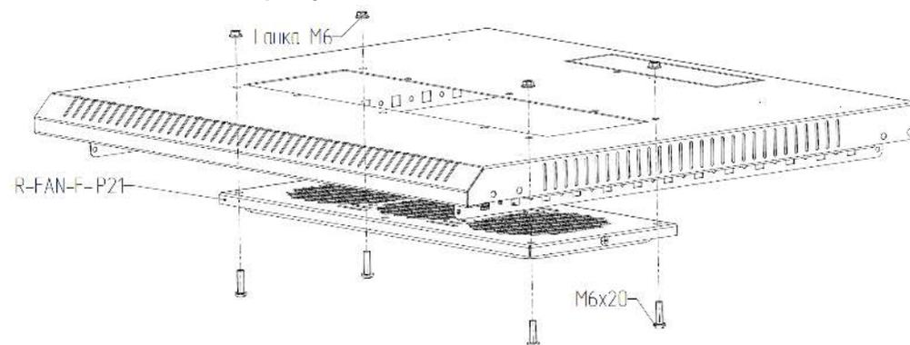
\*В шкафах ШРН/ШТК уплотнитель на фильтре предназначен для лучшего контакта с вентилятором (при его наличии) и исключения паразитного потока воздуха
