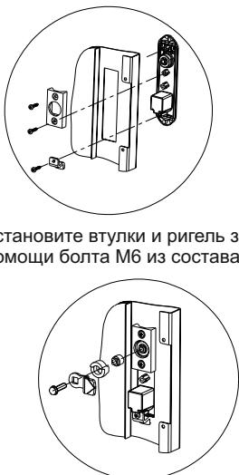
Установите втулки и ригель замки при помощи болта M6 из состава замка.
