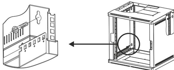
**Установка задней стенки шкафа.** Установите заднюю стенку и зафиксируйте при помощи четырех резьбоформирующих винтов (опция)
