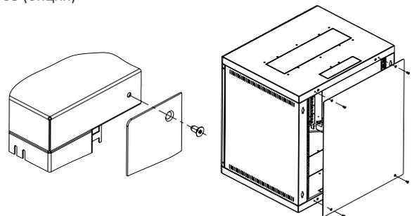
**В верхней и нижней части шкафа предусмотрены кабельные вводы и окна для установки вентиляторных модулей**
