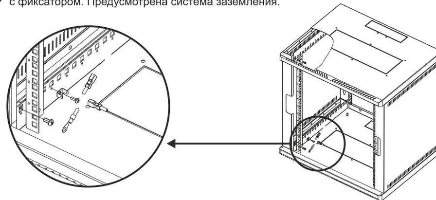
**2** Предусмотрена возможность установки двери с правой или левой стороны. Отведите вниз шпингалет и снимите дверь. Установите дверь. Переустановите замок. Подсоедините провод заземления.
